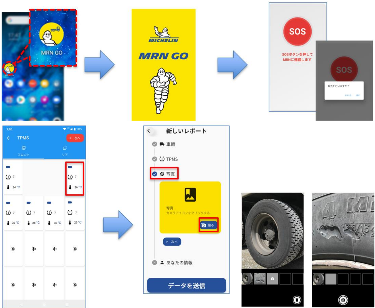
図2 MRN GO アプリケーションのイメージ図：スマートフォンからアプリを起動し、SOS ボタンを押して必要な情報を入力送信
